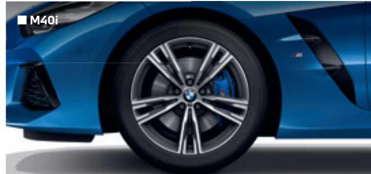
■ M40i Jantes en alliage léger 18" (46 cm) style 798 M, à rayons doubles, bicolores Orbit Grey, avec monte pneumatique mixte
