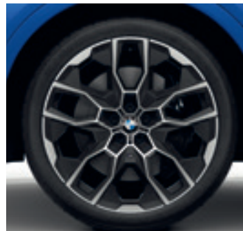
Jantes 22" à rayons doubles style 913 M Pneus avant : 275/40 R 22 Pneus arrière : 315/35 R 22.
