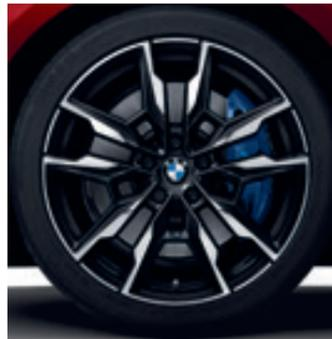
Jantes en alliage léger 19" (48 cm) style 861 M à rayons en Y, bicolors avec pneumatiques mixtes : Avant : 225/40 R19 - Arrière : 255/40 R19
