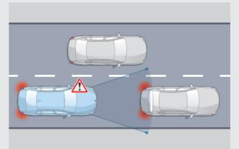
**Détection de collision avant avec freinage**
