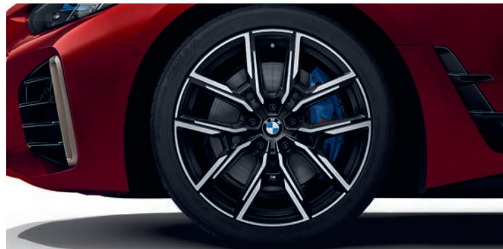
Jantes en alliage léger 19" (48 cm) style 859 M à rayons en Y, bicolores avec pneumatiques mixtes : Avant : 225/40 R19 - Arrière : 255/40 R19
