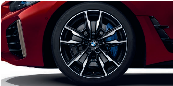
Jantes en alliage léger 19" (48 cm) style 861 M à rayons en Y, bicolores avec pneumatiques mixtes : Avant : 225/40 R19 - Arrière : 255/40 R19
