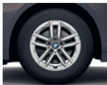
Jantes en alliage léger 16" style 186 à rayons doubles 7 J x 16 / pneus 205/65 R 16
