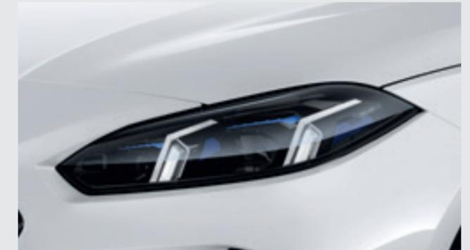
**Pack Advanced Full LED** : L'équipement comprend une gestion automatique des feux de route. La fonctionnalité anti-éblouissement "BMW Selective Beam" avec projecteurs directionnels répartit de façon variable le faisceau lumineux pour un éclairage optimal de la route dans l'obscurité.
